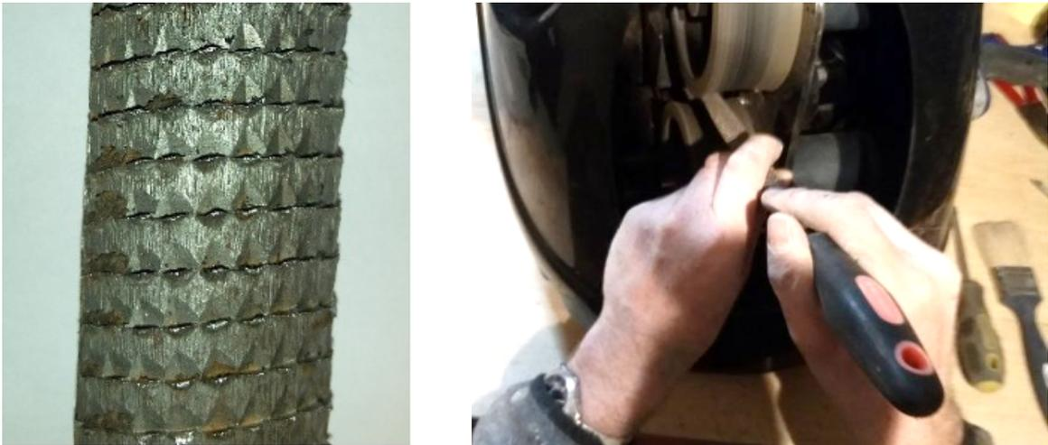
Dazu die Ballmaschine einschalten und bei hoher Geschwindigkeit der Wurfräder mit dem oberen Viertel der Raspelfläche zart an die Gummierung herangehen. Anschließend die abgeraspelte Gummierung absaugen. Vorsicht: Wenn Sie die Raspel zu stark auf das Wurfrad drücken, dann haben Sie ein Loch in der Gummierung.
