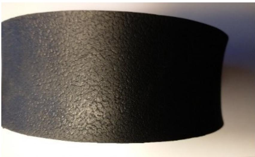
Anfangs kann man die Oberfläche des Wurfrades mit einem grob körnigen (6-30 nach CAMI) Schmirgelpapier säubern. Wenn das Wurf Rad schon ziemlich glatt ist (durch Filz und Ziegelmehr und Dreck), dann sollte man die Reinigung mit einer Metall-Raspel vornehmen.
